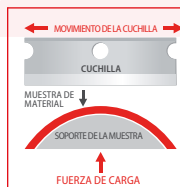
Máquina de pruebas de corte TDM-100 Método de prueba ISO 13997.
